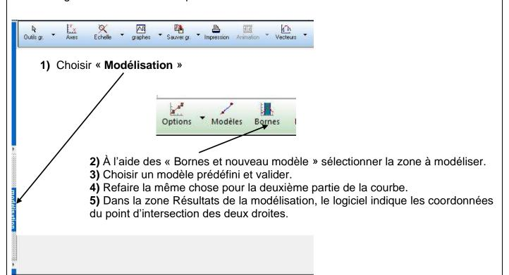
**Document 4** Détermination de l'équivalence lors d'un titrage pH-métrique
