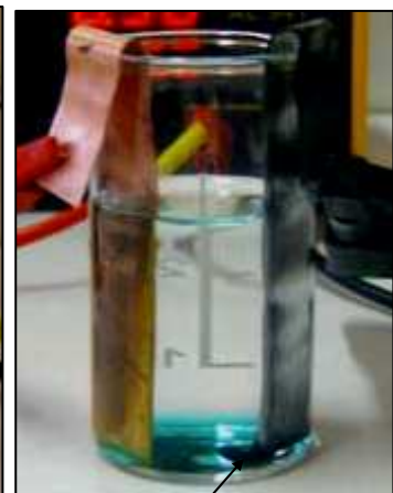
Formation d'un dépôt solide gris sur la lame de zinc
