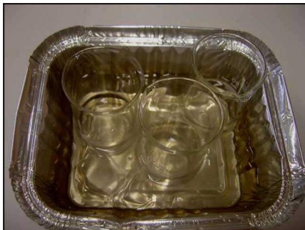
Préparation des béchers dans un mélange eau – glace pour les trempes
