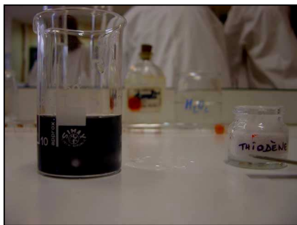
Après ajout du prélèvement au bécher d'eau glacée: on relève la date t de la trempe
