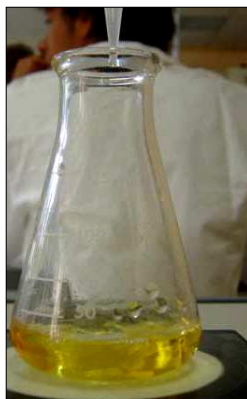
En cours de dosage
