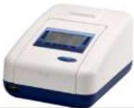
Faire un « blanc avec de l'eau distillée puis effectuer la mesure de l'absorbance de la solution pour une longueur d'onde  $\lambda = 625 \text{ nm}$
