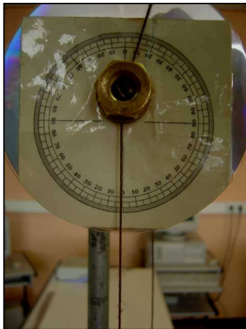
Cercle gradué pour mesurer \alpha
