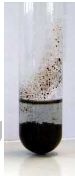
... et décantation. L'oxyde de cuivre solide se rassemble au fond du tube à essai.
